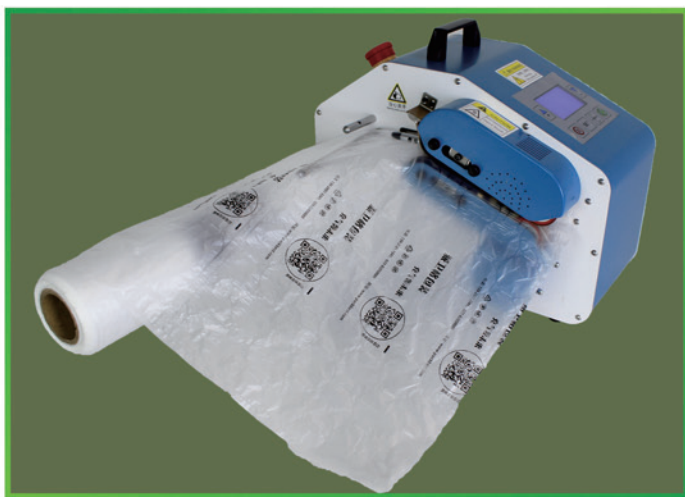
为葫芦卷膜进行自动化充气 and 封口
